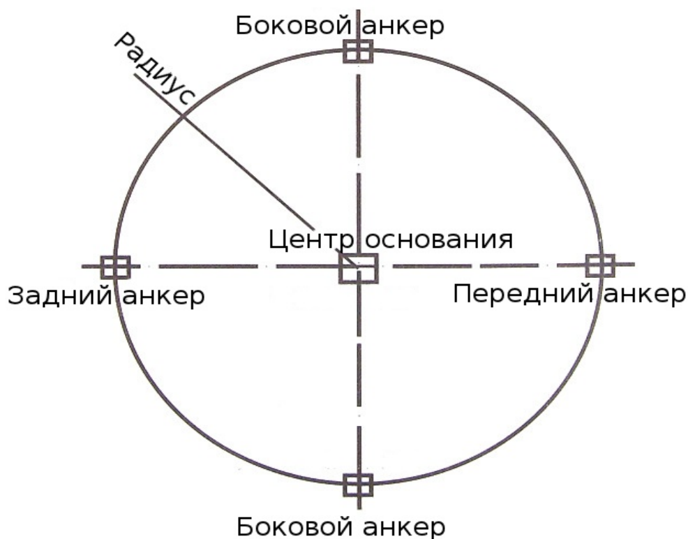
Рис. 1 Расположение центральной опоры мачты и опор анкеров.
